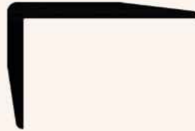
KAPLAMALI ( FOLYOLU ) L KÖŞE (L EDGE CLOSURE)
